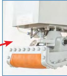
**Le coussin d'air** assure une répartition optimale de la pression et un réglage sûr, même avec des matériaux problématiques et dans des zones de collage difficiles. Le manomètre séparé du tampon de pression indique la pression exacte dans le tampon. Verrouillage à crémaillère et pignon: Après avoir abaissé le patin de presse, un cliquet pneumatique verrouille automatiquement la tige de poussée du vérin.
